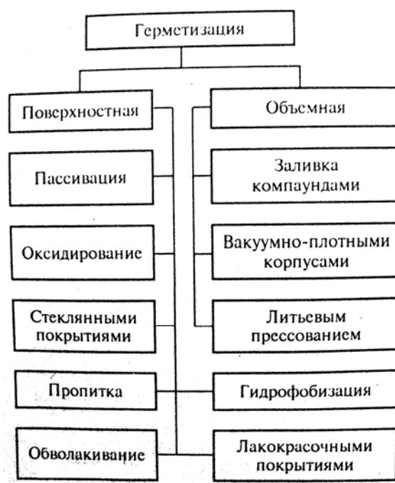
Рис. 22. Классификация методов герметизации
