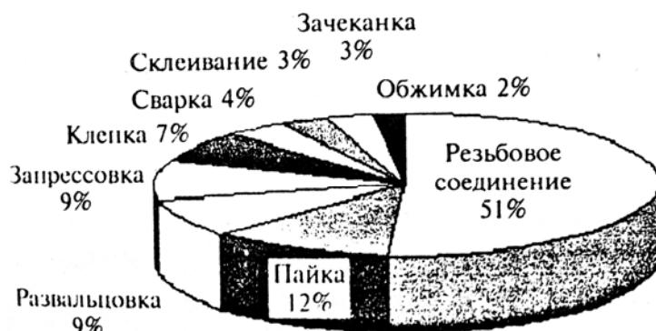
Рис. 3. Соотношение видов механических соединений
